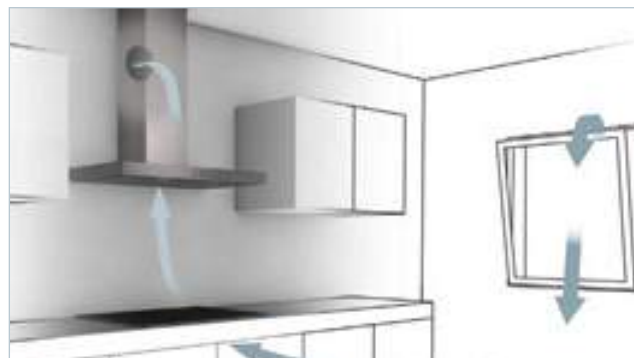
Aspirazione ad espulsione
