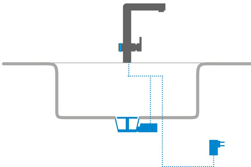
Una volta installata sul lavello, la piletta di scarico automatica inclusa con SMART-TAP, va collegata al miscelatore e all'alimentatore. L'installazione è facile e veloce.
