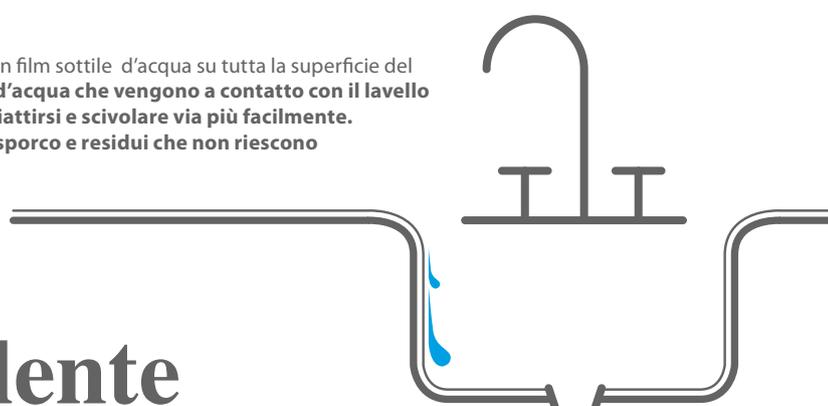
Le nanoparticelle di biossido di titanio, presenti nel materiale, attraggono le molecole d'acqua, formando **un film sottile ed invisibile su tutta la superficie del lavello**. In questo modo le gocce d'acqua che vengono a contatto con il lavello tendono ad appiattirsi e scivolare via più facilmente, **eliminando il deposito di residui sulla superficie**.
