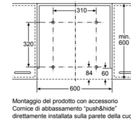
Montaggio del prodotto con accessorio Cornice di abbassamento "push&hide" direttamente installata sulla parete della cucina.
