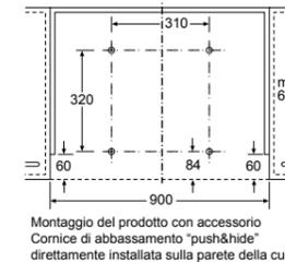
Montaggio del prodotto con accessorio Cornice di abbassamento "push&hide" direttamente installata sulla parete della cucina.
