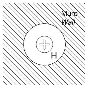
I supporti magnetici (H) vengono fissati alla parete tramite tasselli; il Pannello si appoggia ai supporti magnetici che ne garantiscono la stabilita' e consentono di rimuoverlo e riposizionarlo con facilità'.
