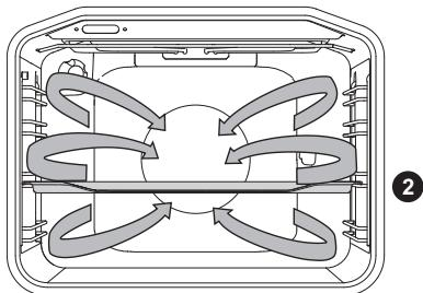
In questo modo funzionano il riscaldatore rotondo e ventilatore. Ventilatore sulla parete posteriore del forno assicura una costante circolazione dell'aria calda intorno alla carne o dolci.
