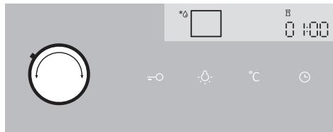
Ruotare la MANOPOLA PER LA SELEZIONE DEL SISTEMA DI COTTURA su scongelamento.
