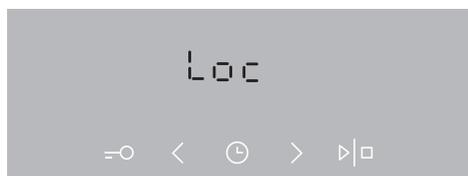
**3** La porta del forno dopo un certo tempo si blocca automaticamente per la vostra sicurezza. Sul display appare la scritta Loc (per 3 secondi).
