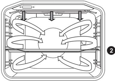
Con questo sistema funzionano simultaneamente il riscaldamento a raggi infrarossi e la ventola. È adatto per la cottura di carne, pesce, verdure.
