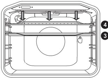
Nel **grande grill** funzionano il riscaldamento superiore e quello a raggi infrarossi che sono installati nella parte superiore del forno.
