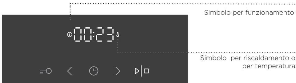
Durante il riscaldamento del forno il simbolo della temperatura lampeggia. Quando il forno raggiunge la temperatura impostata, il simbolo si illumina e si sente un breve segnale acustico.
