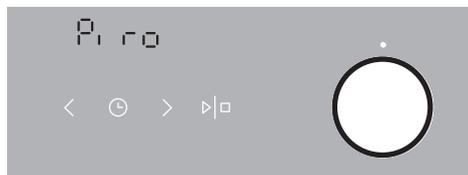
**2** Ruotare il tasto PER LE IMPOSTAZIONI DELLA TEMPERATURA tutto a destra su P. Sul display inizia a lampeggiare la scritta Pyro e la durata del tempo per la pulizia a pirolisi. Toccare il pulsante START/STOP.
