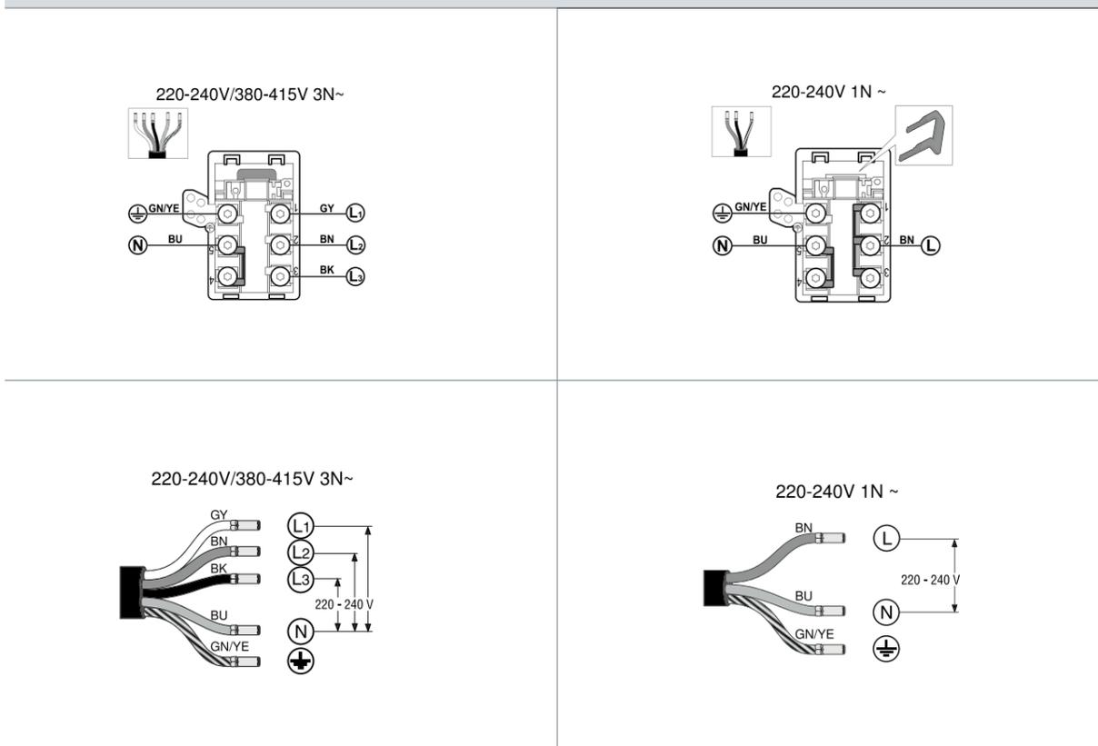
Piani ad induzione 60 cm, 70cm, 80cm, 90 cm con profondità 60 cm e 35 cm: EX875LVB1E, EX875LYV1E, EX675FEC1E, EX801LYC1E, EX275FXB1E, EX775LEC1E, EX652FEC1E, ED875FSB5E, ED675FQC5E e EX675FXC1E
