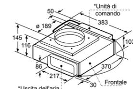
\* L'uscita dell'aria e l'unità di comando sono intercambiabili a vicenda. In caso di necessità l'unità di comando può essere fissato alla parete del mobile
