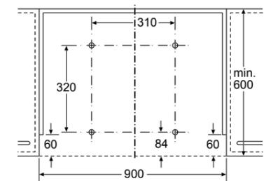
Montaggio del prodotto con accessorio Cornice di abbassamento "push&hide" direttamente installata sulla parete della cucina.
