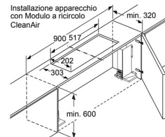
il modulo a ricircolo CleanAir delle Cappe telescopiche non può essere installato con tipologie di pensile con chiusura basculante. Vedi sotto \*\*
