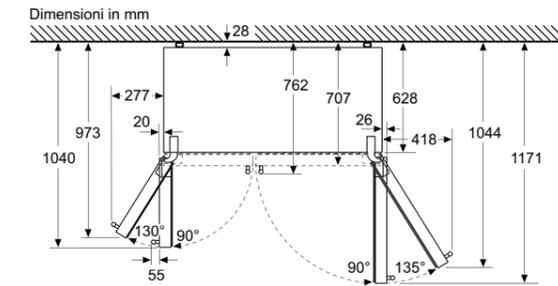
Con un angolo d'apertura anta di 135° i cassetti di raffreddamento possono essere estratti completamente
