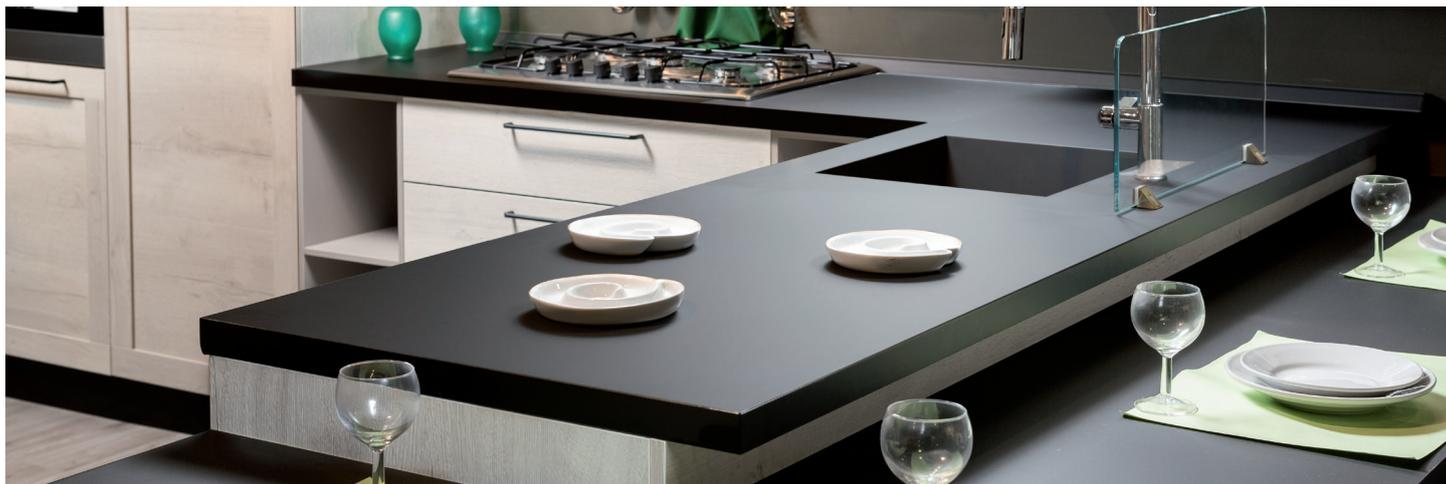
Il Top in Laminato Unicolor è costituito da un pannello di particelle di legno (classe E1) idrorepellente rivestito di un laminato decorativo HPL ad alto spessore (12/10) e colorato uniformemente al suo interno.
