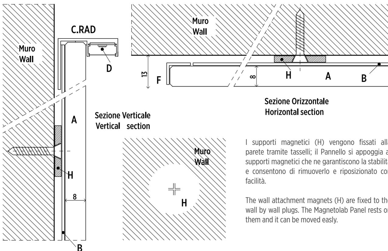
I supporti magnetici (H) vengono fissati alla parete tramite tasselli; il Pannello si appoggia ai supporti magnetici che ne garantiscono la stabilità e consentono di rimuoverlo e riposizionato con facilità.
