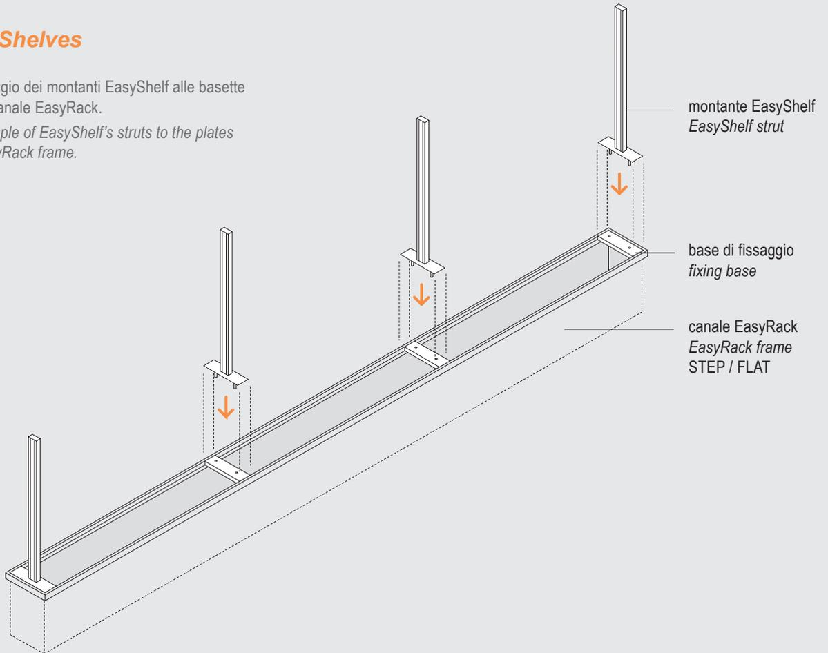
Esempio di fissaggio delle mensole EasyShelf ai montanti.
