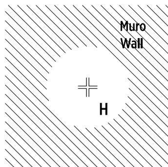
I supporti magnetici (H) vengono fissati alla parete tramite tasselli; il Pannello si appoggia ai supporti magnetici che ne garantiscono la stabilità e consentono di rimuoverlo e riposizionarlo con facilità.
