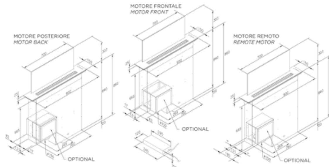
L'installazione, sia in versione filtrante che aspirante, può prevedere l'utilizzo di un motore dedicato oppure di un motore remoto ad una distanza consigliata massima di 6 metri.
