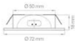
Faretto LED da incasso o superficie 1,8W - 12V Distanziale montaggio superficie H 15mm diametro totale 70 mm altezza 18 mm temperatura 4000 °k finitura satinato
