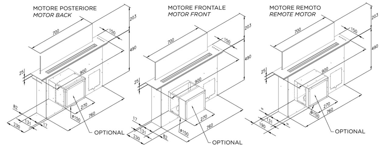
L'installazione, sia in versione filtrante che aspirante, può prevedere l'utilizzo di un motore dedicato oppure di un motore remoto ad una distanza consigliata massima di 6 metri.
