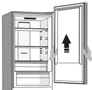
5. Rimuovere il cappuccio di copertura (destra) (4) dalla busta e posizionarlo sul punto in cui è stato rimosso il cardine superiore. Rimuovere e conservare il cappuccio di copertura dall'altro lato (5) in cui verrà collocato il cardine.
