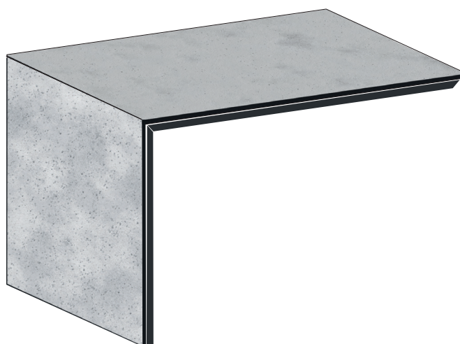
2. Taglio a 45° per montaggio a L*
